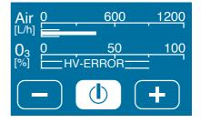
Elemento ozonizador dañado (por ej. ingreso de agua o partículas de suciedad). Apague el generador de ozono y quite el enchufe de alimentación. Limpieza del elemento ozonizador. Haga burbujear aire para eliminar el agua que haya ingresado. Si después de esto el problema persiste, es necesario enviar el ozonizador a una inspección.
