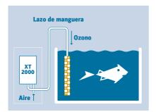
También puede ubicarse sin más el ozonizador perfectamente dentro de un armario técnico. En este caso será necesario prever una buena ventilación para evitar el sobrecalentamiento del equipo. Si se instala el ozonizador dentro de un armario habrá de preverse un lazo de manguera hacia arriba, con el objetivo de evitar un retorno del agua.
