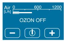
El indicador de barra superior (»Air«) indica la magnitud del caudal de aire que atraviesa el equipo (en L/h).
