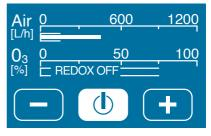
Si se alcanza el valor ajustado en el regulador redox, se apaga la generación de ozono. Si el valor de redox desciende por debajo del programado, se vuelve a encender la generación de ozono.
