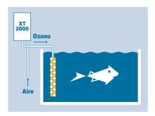
En la parte posterior del ozonizador hay dos bridas de sujeción. Con ellas puede fijarse el dispositivo a la pared. En la medida de lo posible, se lo debe instalar por encima del nivel del agua. Esto evitaría, por ej. que ingrese agua de retorno al equipo en caso de un corte de energía.
