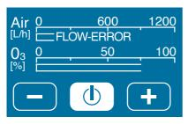
El caudal de aire es inferior a 250 L/h. El aparato se apaga para protegerse del sobrecalentamiento. Controle la entrada de aire, elimine eventuales atascos.
