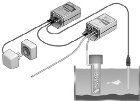
Ein Sander Ozonisator der Baureihen Certizon oder S muss mit der mitgelieferten Verbindungsleitung (8) angeschlossen werden. Als Spannungsversorgung des Messgeräts kommt das mitgelieferte Netzteil des Ozonisators zum Einsatz.
